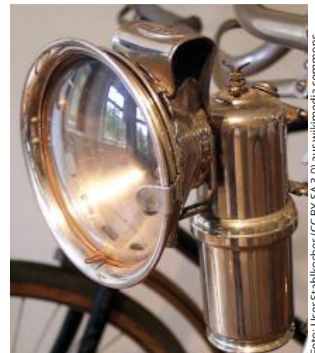
Karbidlampe um 1896, die erste brauchbare, aber umständliche Fahrradlampe.
